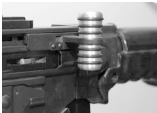
Figura 18: Leva d'armamento anatomica per F ass 57
