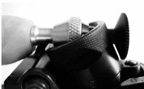
Figura 5: Sistema di filtri colorati Wyss innestabile
