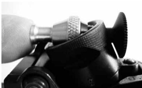
Bild 5: Farbfiltersystem Wyss, aufsteckbar
