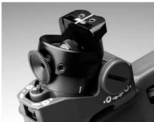
Figure 4: Filtres colorés excentriques avec cassette coulissante, modèle Grünig & Elmiger; modèle Wyss semblable
