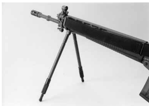
Bild 2: Verstellbare Zweibeinstütze zu Stgw 90, diverse Fabrikate
